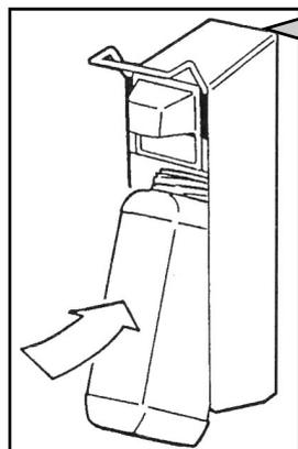
Insérer la recharge dans la tubulure de la pompe et la plaquer contre le fond du distributeur sur l'arête prévue à cet effet.
