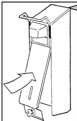
Introduire la façade entre la recharge et le bec verseur et fermer à clé.
