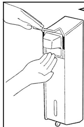
Avant la première mise en service, appuyer à plusieurs reprises sur le levier jusqu'au bon écoulement du savon. Bien tenir la main ouverte sous le débit.
